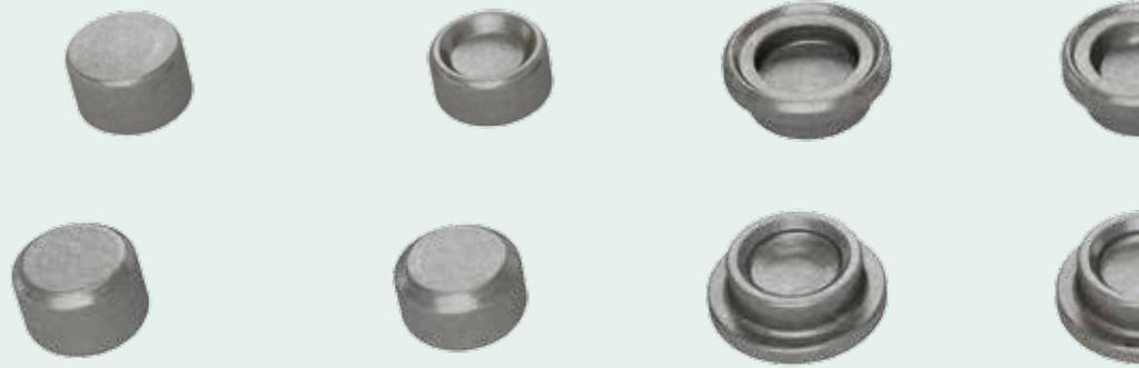
*Moderne Mehrstufen-Pressen bearbeiten das Werkstück auf beiden Seiten*
