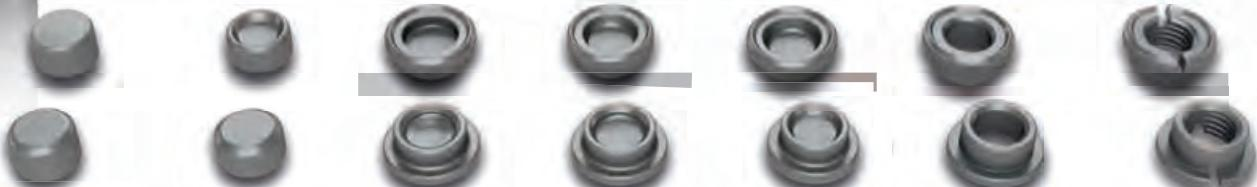
Kaltumformung bedeutet, dass Abschnitte von Draht ohne Zuführung von Hitze unter Druck in zwei- oder mehrstufigen Werkzeugen umgeformt werden. Der Vorteil dieses Verfahrens liegt in der hohen Fertigungsgeschwindigkeit und vor allem in der optimalen Materialausnutzung. Während beim Drehen und Stanzen verfahrensbedingt Materialverluste von bis zu 50% nicht unüblich sind, liegt der Verlust bei der Kaltumformung in der Regel nur bei 10 – 15%.
