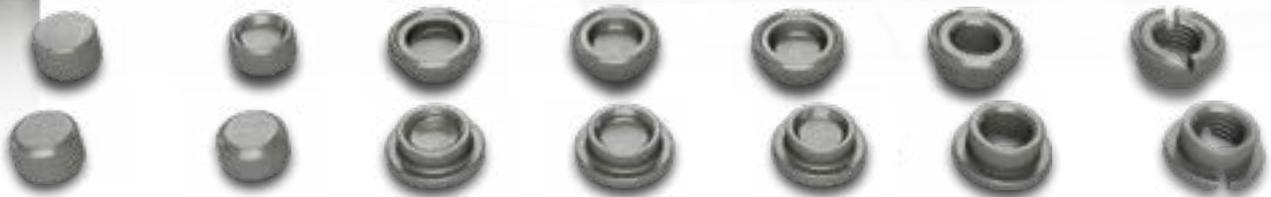
Kaltumformung bedeutet, dass Abschnitte von Draht ohne Zuführung von Hitze unter Druck in zwei- oder mehrstufigen Werkzeugen umgeformt werden. Der Vorteil dieses Verfahrens liegt in der hohen Fertigungsgeschwindigkeit und vor allem in der optimalen Materialausnutzung. Während beim Drehen und Stanzen verfahrensbedingt Materialverluste von bis zu 50% nicht unüblich sind, liegt der Verlust bei der Kaltumformung in der Regel nur bei 10 – 15%.
